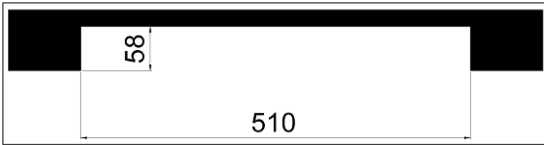
Fig. 7 - Perforación de pezuña:
